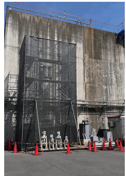
図5 高負荷担体式嫌気処理のパイロット試験装置外観 Pilot-scale experimental setup for high-load carrier anaerobic treatment
