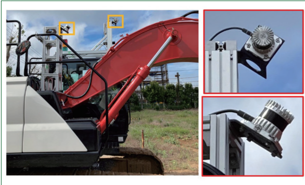
図2 ショベルに設置された LiDARのうち、車体上のもの LiDAR mounted on machine, installed on vehicle body
