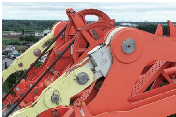
図4 実際の点検画像：接続ピンや割りピンの挿入状態 Actual inspection images : Status of joint pins and split pins inserted
