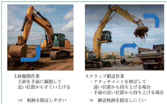
図4 機種ごとの搬送軌跡の違い Differences in transport trajectories
