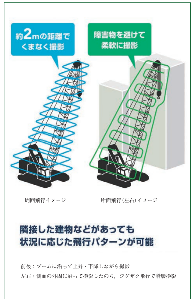
図7 片面自動飛行イメージ Single-sided automatic flight image
