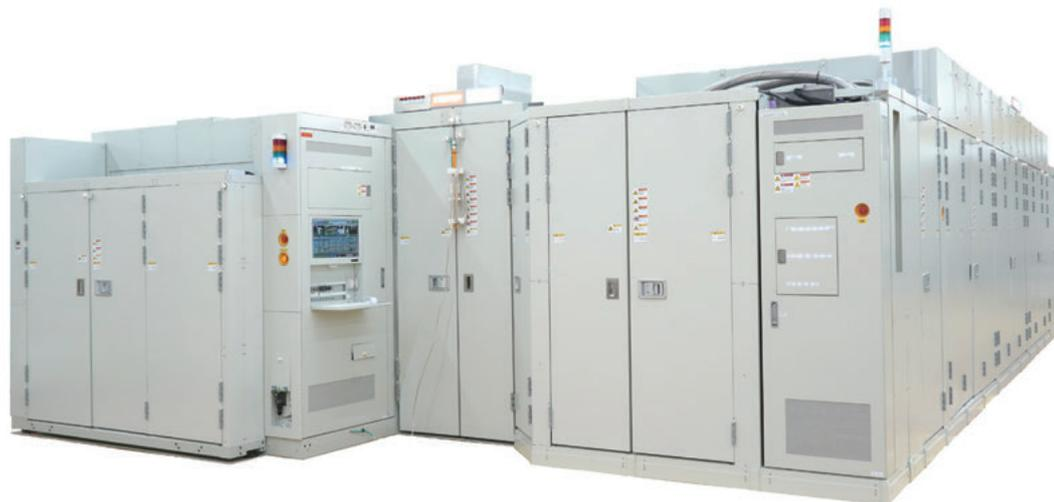
本装置SS-UHE IIは、超高エネルギーでのイオン注入プロセスに対応した300mmウエハ用枚葉式超高エネルギーイオン注入装置SS-UHEの後継機である。従来機SS-UHEは、CMOSイメージセンサデバイスの微細化や高性能化に伴い、フォトダイオード部へのイオン注入がより深く、より正確に行えるように、注入エネルギーを旧機種種の最大2倍に高め、注入角度精度を大幅に向上させた。
