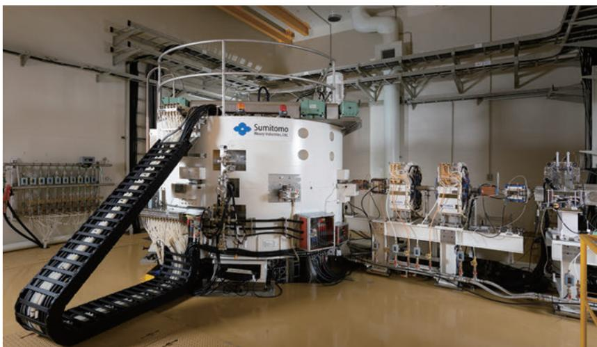
図2 新しく開発され、西条工場に設置された超電導サイクロトロン (SC230)
