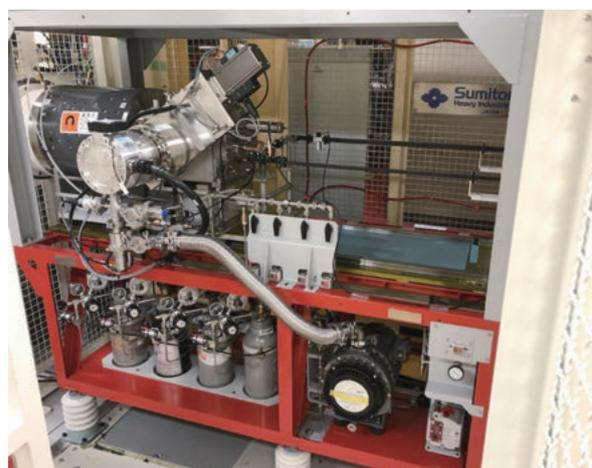
図4 HIMACに設置したマルチイオン源
