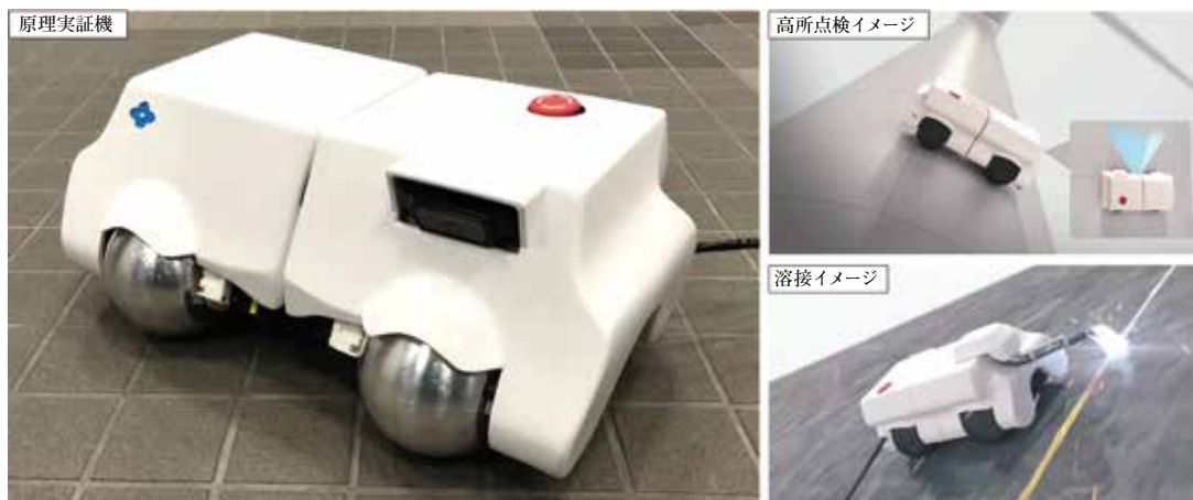
図 1 壁面走行ロボット原理実証機および活用イメージ Proof-of-concept of wall climbing robot and application examples
