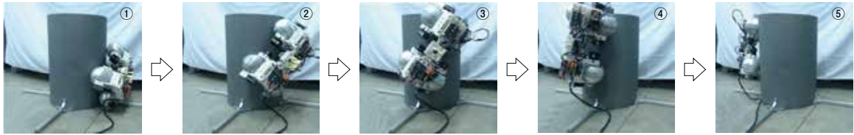
図7 円筒面上の旋回動作 Turning on a cylindrical wall
