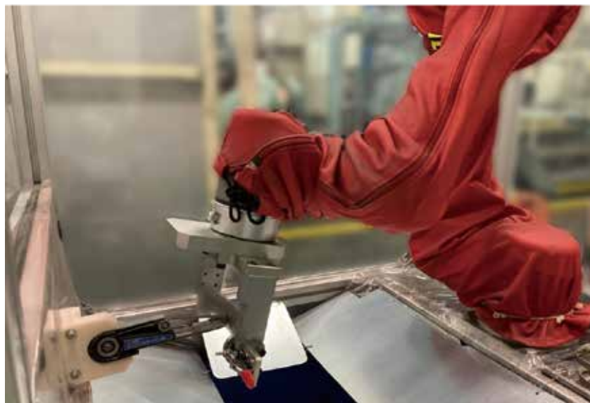
ベルト研磨自動化システム Belt grinding automated system
