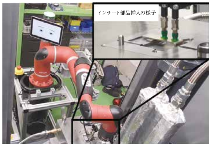
図4 縦型インサート成形における金型へのインサート部品挿入 Insertion of parts in mold
