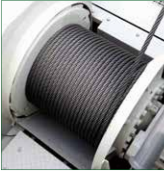
図3 減速機内蔵型 フリーフォール付きウインチ Winch with installed reduction gear
