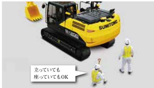
図2 人検知機能 Human detection function
