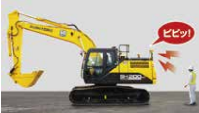
図4 周囲アラーム Alarm to surrounding construction machinery
