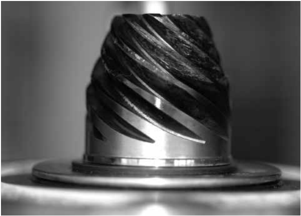
図5 ピニオンギヤの損傷 Failure of pinion gear
