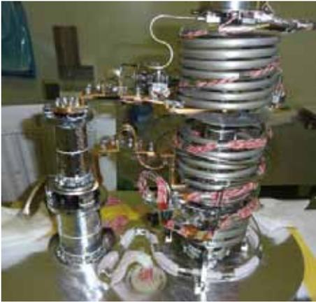
図4 4 K冷凍機(熱交換器, 予冷機のコールドヘッド)
