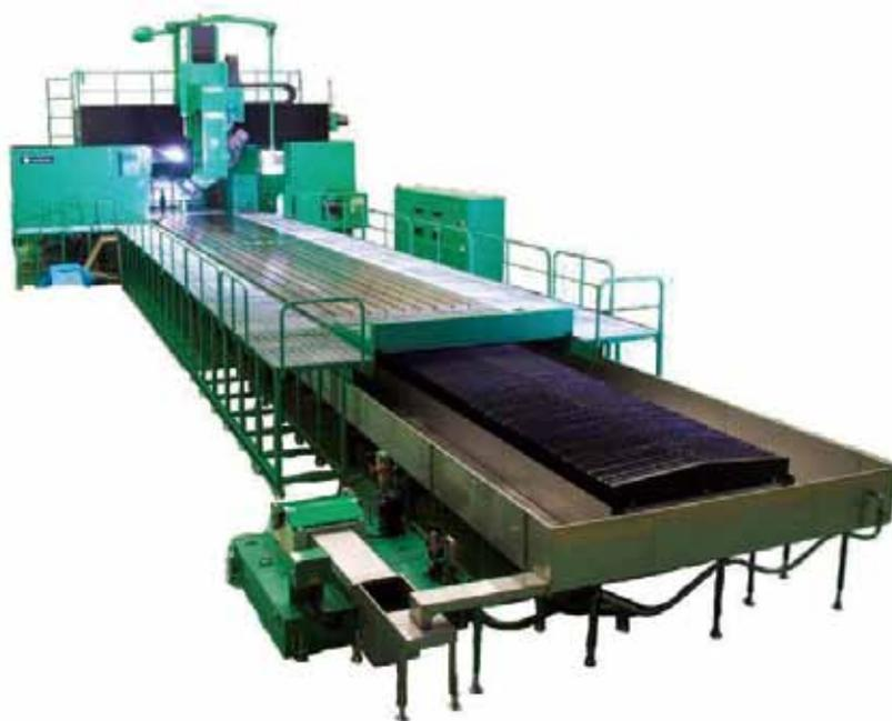
クロスレール固定門形平面研削盤KSL-F22150 (U)は、旋回といし頭1頭、クロスレール固定形とし、工作機械および産業機械の摺動面、金型、各種治工具、一般工作機械の部品など、あらゆる幅広ワーク・超長尺の高品位研削加工への対応を目的に開発した研削盤である。
