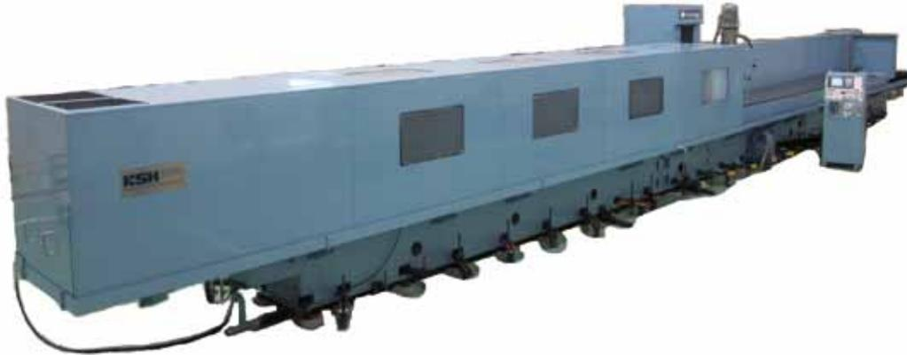
精密平面研削盤KSH-870は、工作機械および産業機械の摺動面、金型、各種治工具、一般工作機械の部品など、あらゆる高精度・高品位研削加工に最適な研削盤である。最大ワーク長さ7mの研削に対応し、総型ドレスによるといし成形で複雑なワーク形状を効率良く研削することができる。
