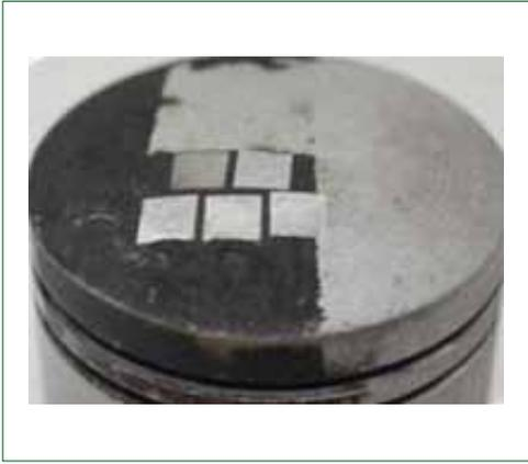
図5 金属塗装膜の除去
