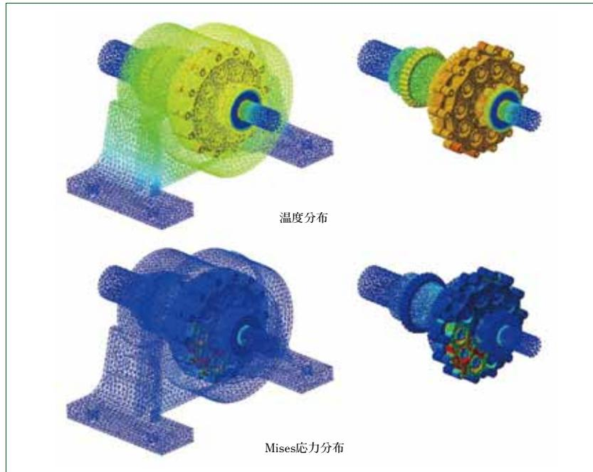
機構・弾性・熱・温度場の連成解析結果
