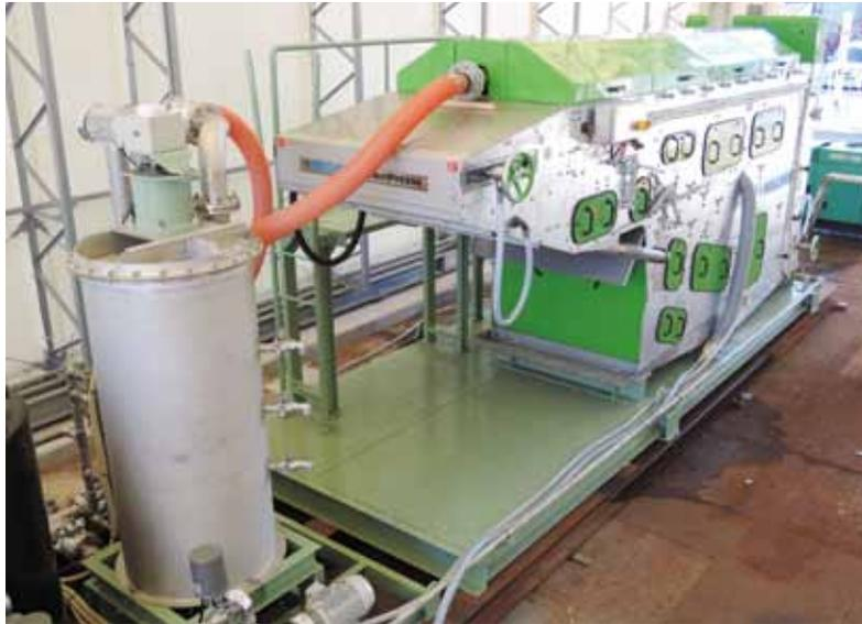
図1 ベルトプレス脱水機
