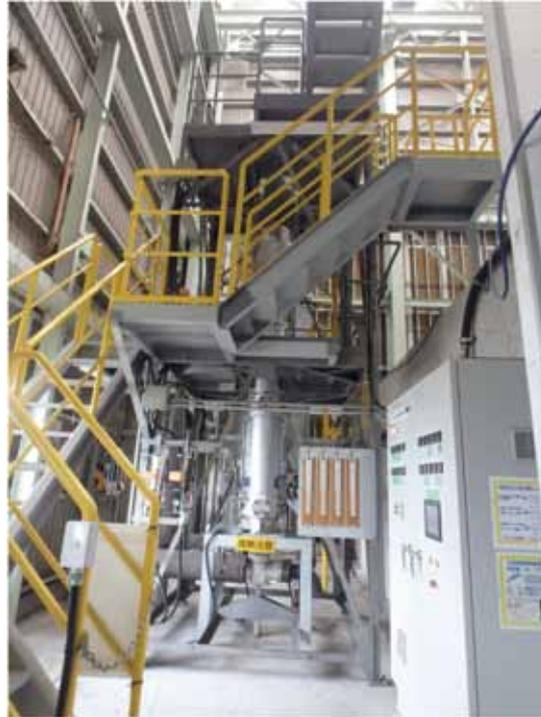
デポジット評価試験装置
