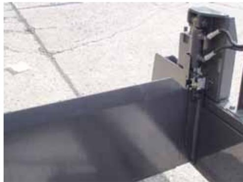
図7 伸縮モールドボード油圧上下機構
