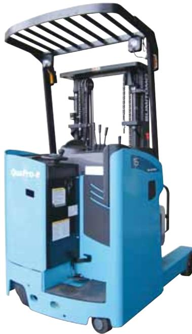
新型リーチフォークリフトFBRは、VOC(顧客要求)をベースとした基本コンセプトである「小回り性と省エネルギー」を実現し、お客様に満足いただける4つの特徴(作業性、経済性、快適性および安全性)を兼ね備えたリーチフォークリフトである。小回り性については、車両レイアウトやマスト引込み量などの改善により、業界最小の直角積付け通路幅を達成し、作業効率、保管効率および疲労度を大幅に改善した。省エネルギーについては、新モータの採用や制御の最適化などにより、規定のサイクルパターンにおいて、消費電力量を従来型比率で24%削減し、業界トップの消費電力量の低減を達成した(JIS D 6202:2011, FBR15-260Ahバッテリーでの比較)。
