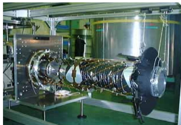
図6 サンプル採取機構(ホーン部)外観写真 Photograph of sampler mechanism (Horn part)
