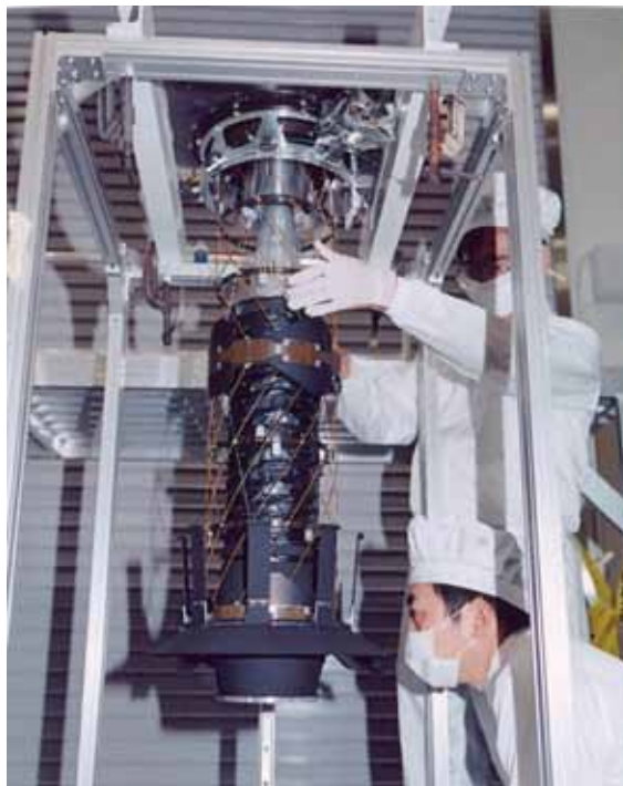
サンプル採取機構 ホーン部 Hayabusa Sampler (Horn part)
