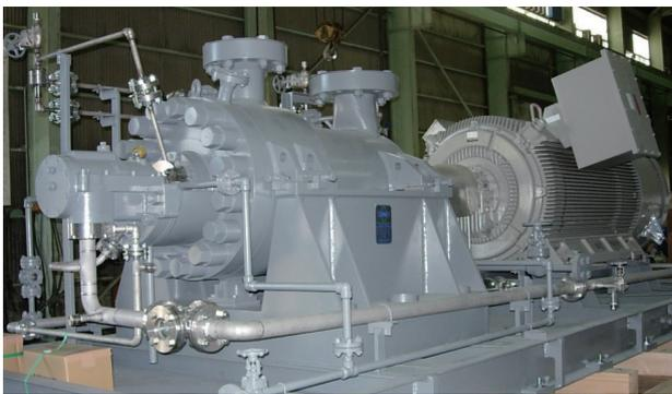
図3 バレル型高圧多段ポンプ (BTBF型)
