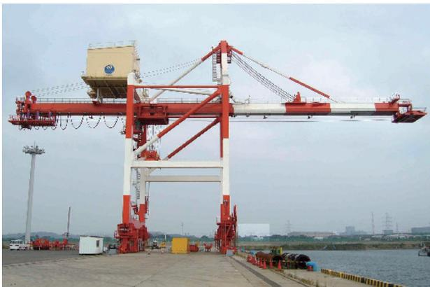
図4 コンテナクレーン (免震装置付き)
