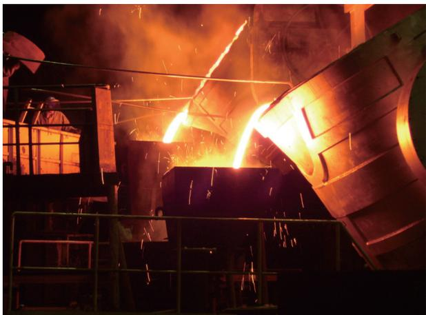
図2 鑄造（静置鑄造）
