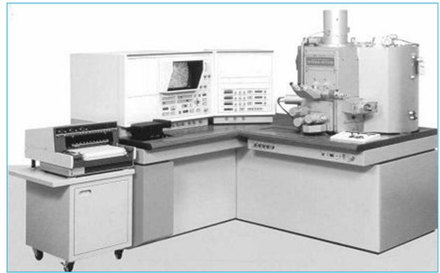
図4 EPMA (電子線マイクロアナライザ)
