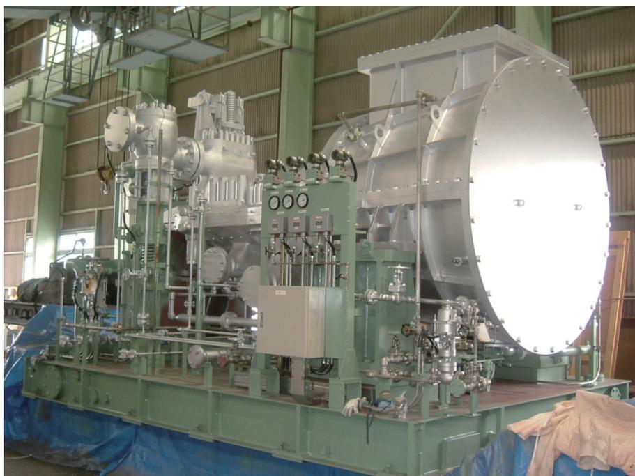
図1 大型多段タービン (C10型)
