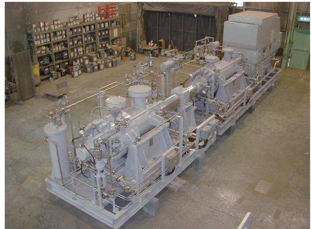
図4 バレル型高圧多段ポンプ & 動力回収タービンユニット
