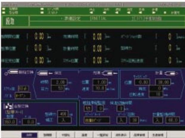
図4 型締力調整時の制御の設定画面
