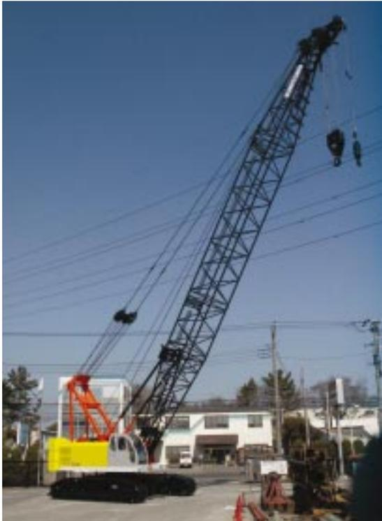
油圧式クローラクレーンのニューラインアップとして、PAX MAGUNAシリーズを開発し、その第一弾として最大吊上げ能力90tのSC900HD-3を2002年3月に販売を開始した。
