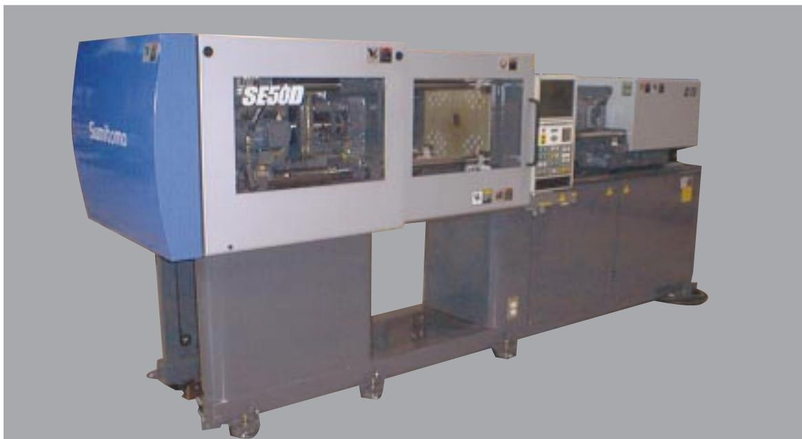
本機は低イナーシャ、ダイレクトドライブ機構による高応答及び高速性を特長とする全電式動射出成形機『SE-Dシリーズ』（型締力290～1760kN、全6機種）に、ピックアップレンズをはじめとする、高精度レンズ部品成形用のアプリケーション及び専用スクリュを搭載したSE-Dシリーズ専用機である。
