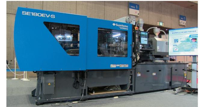
最大型締力：1800kN スクリュ径：φ36mm
