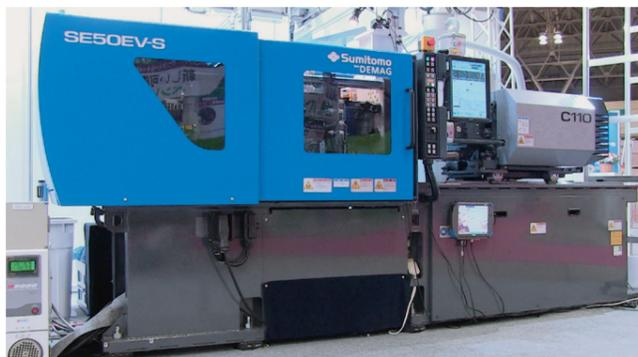
最大型締力：500kN スクリュ径：φ25mm
