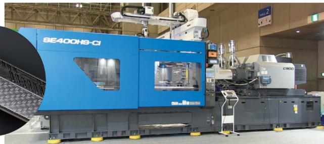
最大型締力：4000kN スクリュー径：φ50mm/φ50mm
