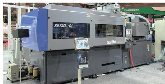
最大型締力：730kN スクリュー径：φ20mm/φ20mm
