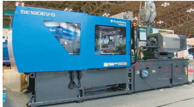
最大型締力：1800kN スクリュ径：φ45mm
