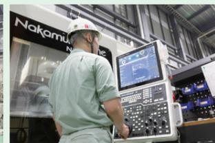
ノズル製造エリア(複合旋盤)
