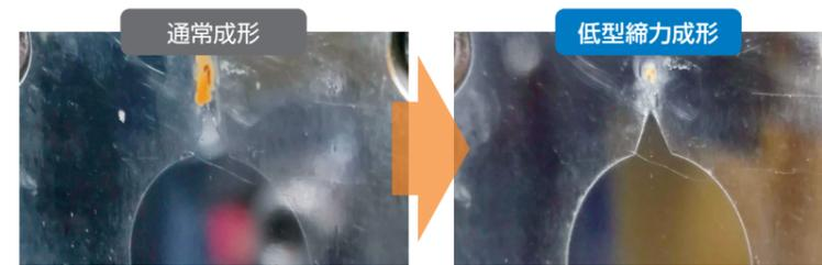
ガスによるモールドデポジットが発生
