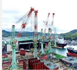
ジブクレーン
