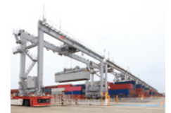
遠隔操作RTG
