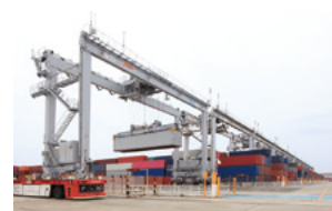
遠隔操作RTG
