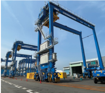
遠隔操作RTG
