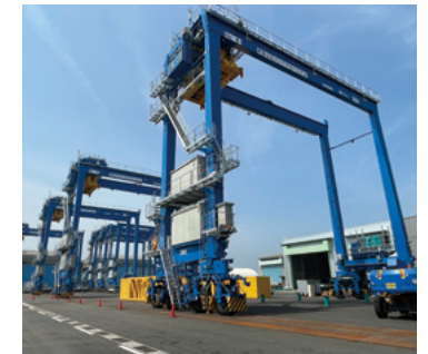
遠隔操作RTG
