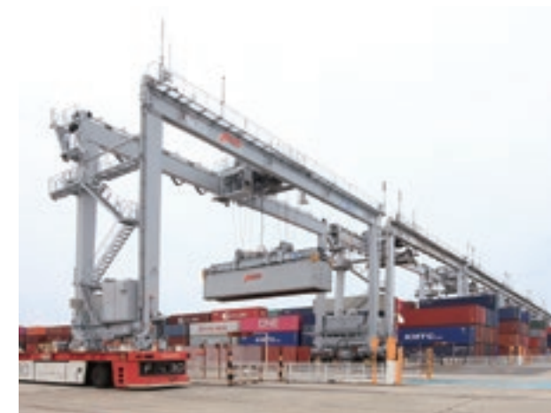
遠隔操作RTG
