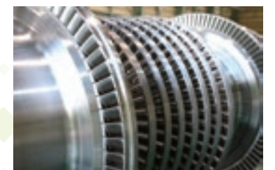
蒸気タービン
