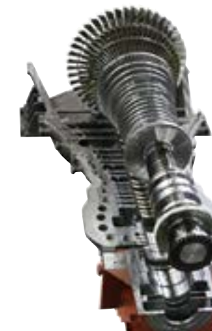
蒸気タービン
