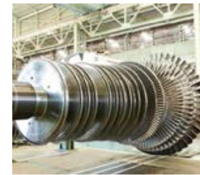
蒸気タービン
