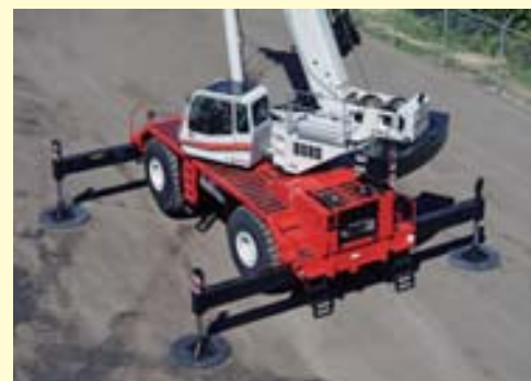
ラフテレーンクレーン
