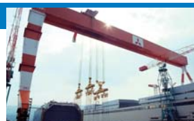
ゴライアスクレーン
