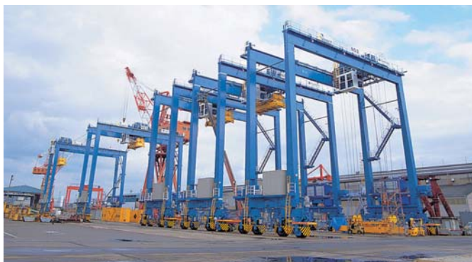
トランスファクレーン
