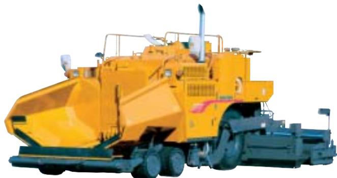
乳剤散布機能搭載型タイヤ式アスファルトフィニッシャー
