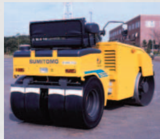
道路機械振動ローラ
