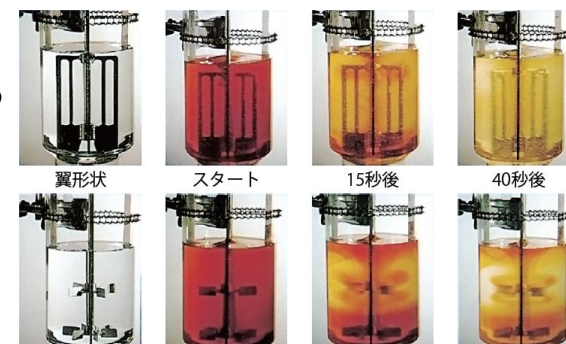
ヨウ素脱色反応による混合時間の比較 (攪拌が進むほど液が透明になる)
