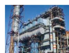
排ガス中のSOx、NOx、ダイオキシンなどの処理に貢献します。水を使用せずに排ガス処理ができます。
