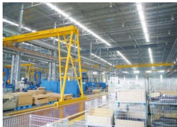
インドネシア建設機械工場 天井が高いが、明り取り窓により日中は工場照明が必要ない。
