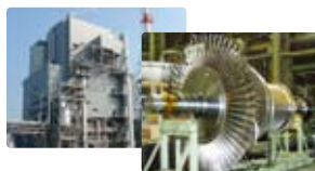
循環流動層(CFB)ボイラ・蒸気タービン
