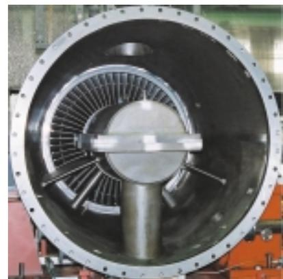
写真：ニューアプリケーション SNM軸流排気型蒸気タービン
