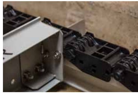
図3 フライト取付け部 Flight mounting part
