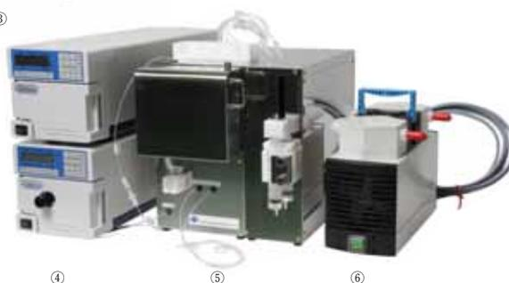
MPS200A $\beta$ は、PET診断用標識化合物であるflorbetapir ( $^{18}\text{F}$ )注射液用の合成装置である。当社では、これまでにがんの診断に用いられる $^{18}\text{F}$ -FDG用の合成装置(F100, F200, F300)、心疾患の診断に用いられる $^{13}\text{N}$ -アンモニア用の合成装置(N100)の医療機器化を行ってきた。
