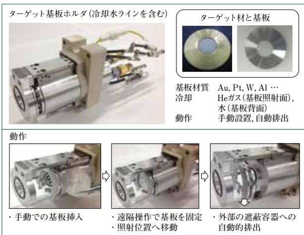
図1 小型サイクロトロン用金属ターゲットシステム
