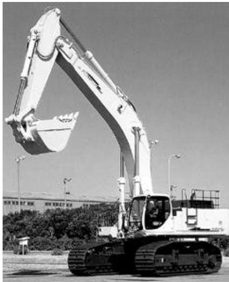
Neo-Power PAXシリーズに80t油圧ショベルを加え大型機種ラインアップを充実させるとともに、人と環境に優しい油圧ショベルとして、排出ガス2次規制対応エンジンを採用、低騒音でも厳しい欧州2次規制に対応している。国内外の砕石/マイニング、海洋土木、大規模工事でのニーズに対応できる大型油圧ショベルである。
