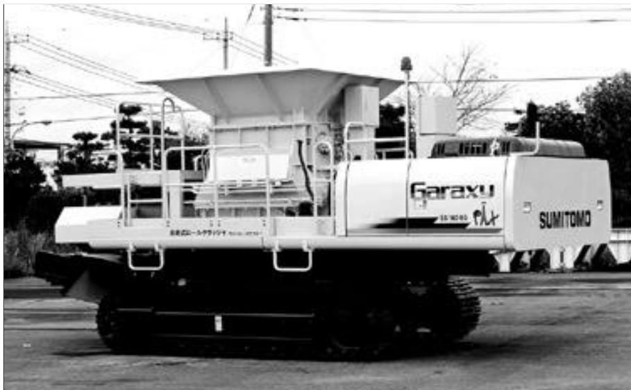
建設解体廃棄物の増大と規制強化に対応するため、現場内処理及び再利用を図ることを目的とした自走式ガラ破砕機を開発した。
