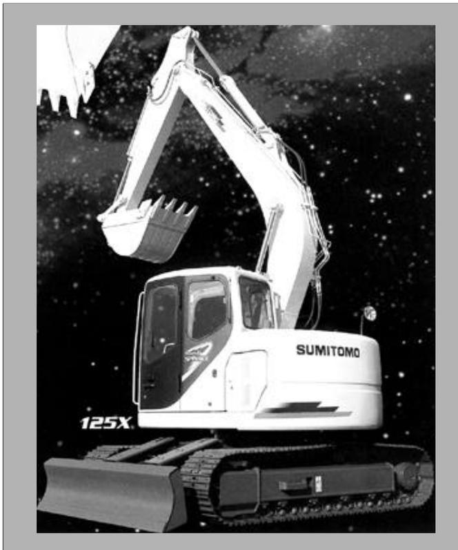
本開発は、標準バケット容量0.28m<sup>3</sup>、0.45m<sup>3</sup>クラスの後方超小旋回型油圧ショベル及び超小旋回型油圧ショベルをフルモデルチェンジし、SH75X、SH75XU、SH125X、SH125XUとした。また、標準バケット容量0.5m<sup>3</sup>クラスの後方超小旋回型油圧ショベルを新たに設定し、SH135Xとしたものである。
