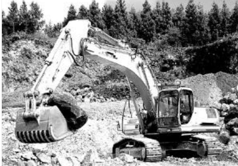
建設工事現場では、大型機械の導入によるコスト削減・工期短縮とともに、環境保全及び安全への対応が強く求められており、30t以上のクラスの大型ショベルにも大作業量の確保・耐久性の向上に加え、燃費、排ガス及び騒音の低減など環境への対応と安全機能向上への要望がますます強くなっている。
