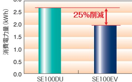
駆動部品の低慣性化、摩擦低減により
