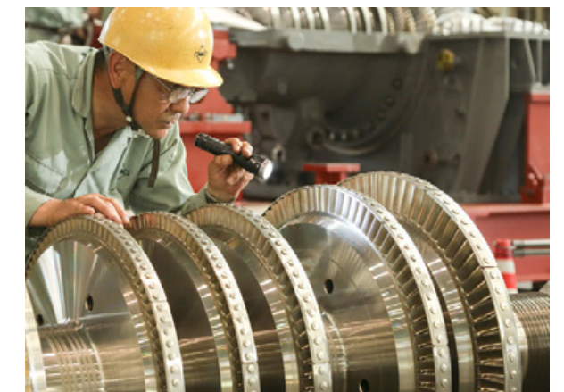
蒸気タービン
